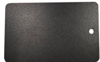
4. Standardstruktur mit einer HVLP-Lackierpistole, 1,6 bis 2,0 mm
